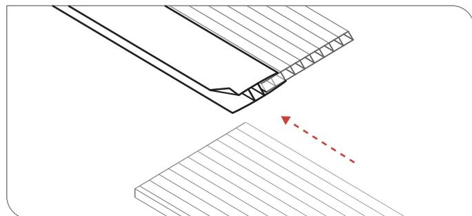
• Abrir un extremo del perfil e introducir a presión un extremo del policarbonato y deslizarlo a lo largo del perfil.
