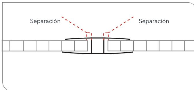
• Dejar separación entre las planchas y perfil H para permitir la dilatación del policarbonato.
